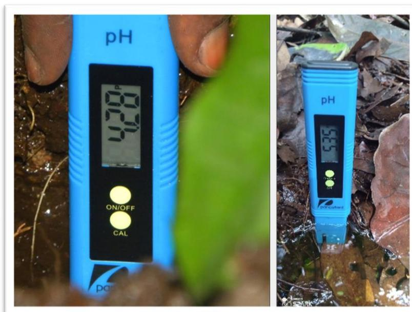
Figure 16. Mesure in situ du pH de l'eau
